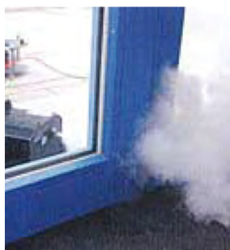
Test de fumée, source AIE 37
