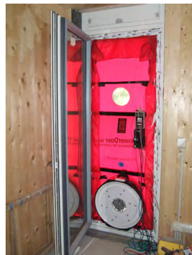
blower door test, Source Modelmo, photo M. Opdebeeck
